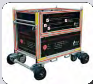
Einstellung der Spurbreite: Straßenbahn (1000mm)
