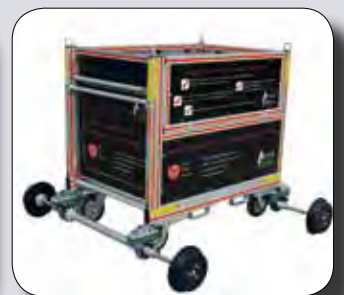
Einstellung der Spurbreite: DB-Spurbreite (1435mm)
